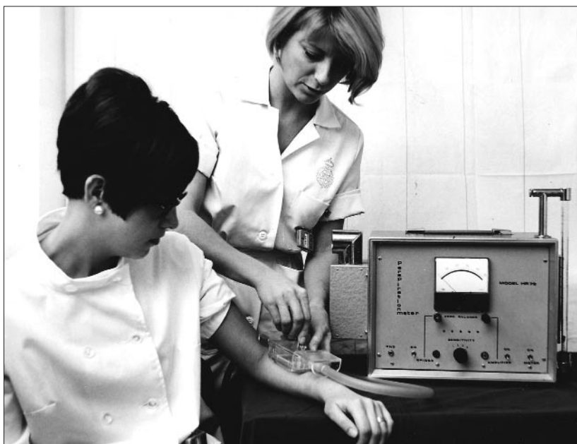
Miernik pocenia („Perspiration Meter”) konstrukcji doktora Henryka Ryżko
