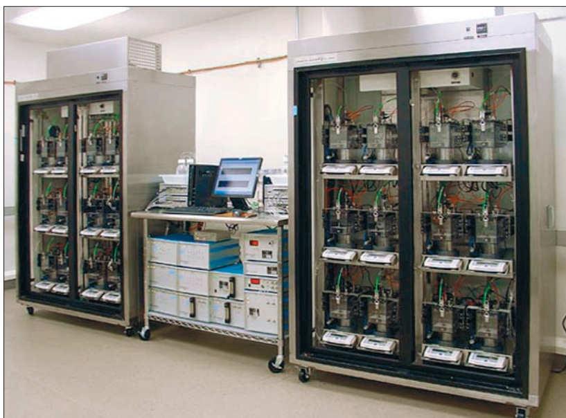
Kombajn „Oxymax-CLAMS” do pomiarów fizjologicznych myszy
